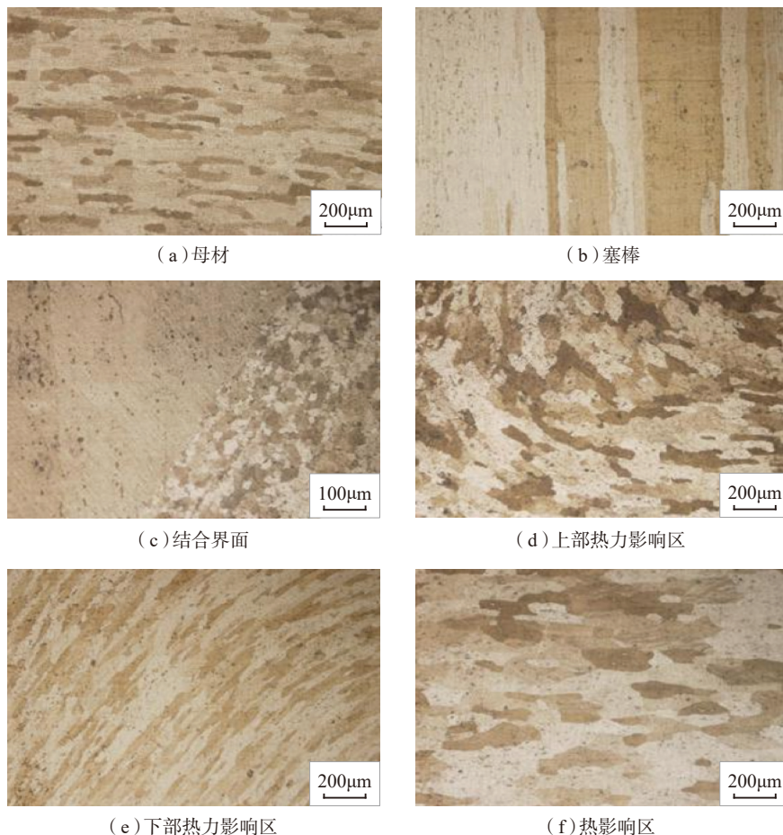
图18 2219铝合金FPPW接头上不同区域的金相组织
