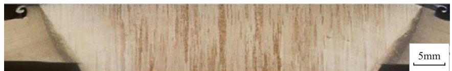
(b) 焊接压力 20kN、拉锻力 20kN
