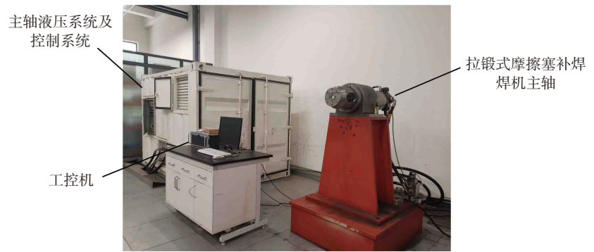
图3 拉锻式摩擦塞补焊设备
