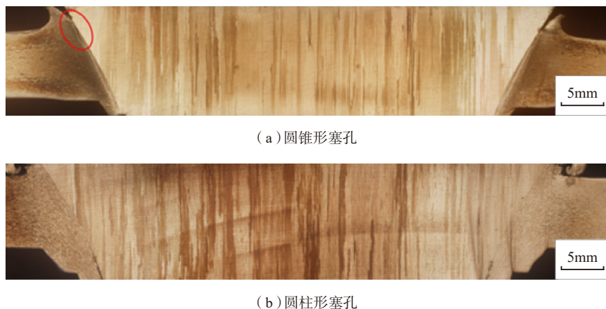
图12 圆锥形塞孔和圆柱形塞孔接头截面形貌
